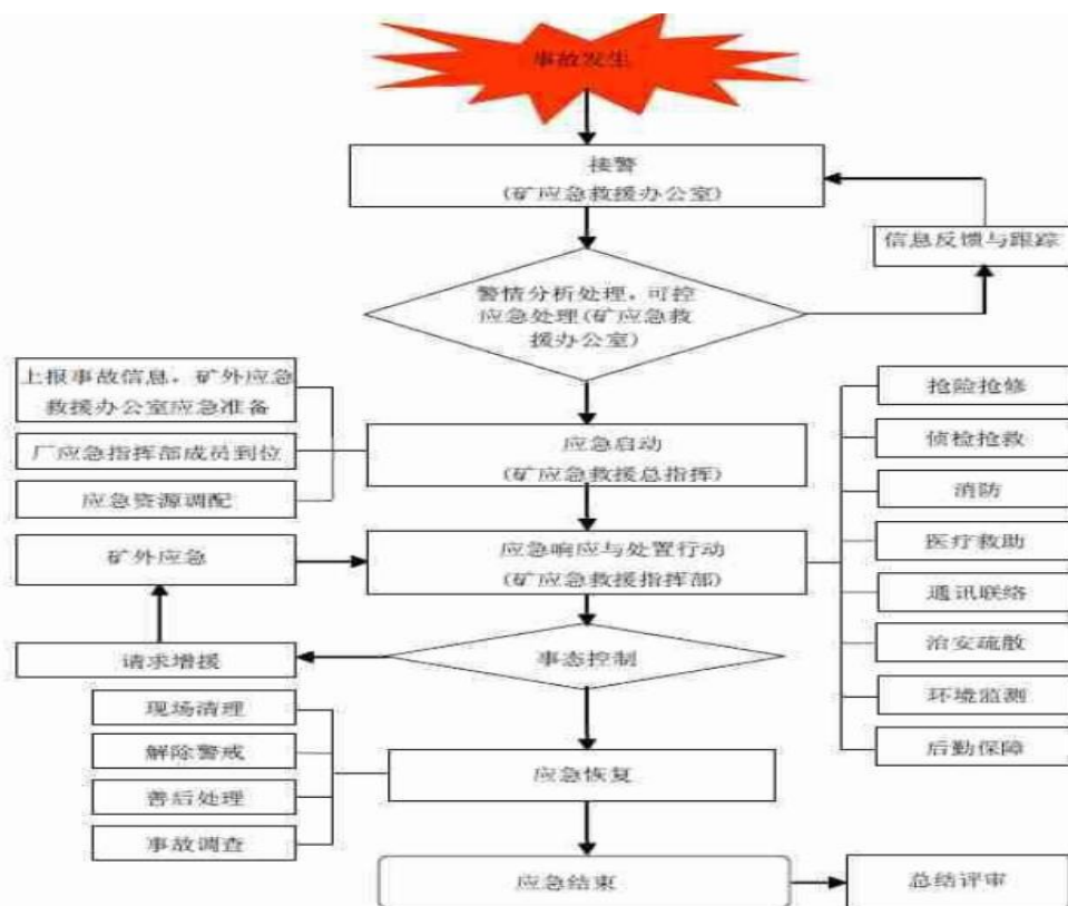
图6.4-1 矿山应急响应流程
